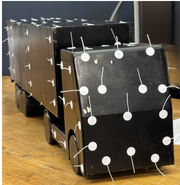
Figur 3.13: Lastbilsmodell utan luftavvisare med garntuftar monterade med tejp.
