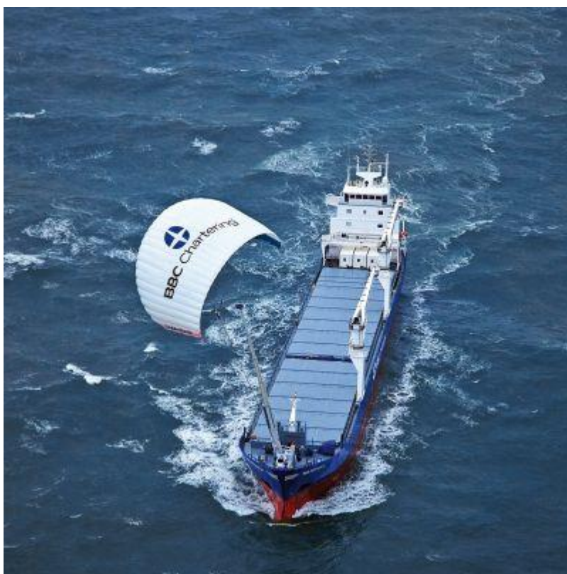
Figur 7 Kite för extra framdrivning på växellastfartyg
