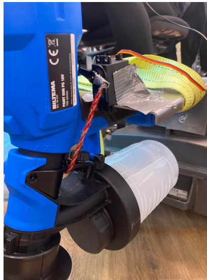
Figur 3.16: Figuren visar en servomotor monterad på hållaren för färgsprutan som vid rotation drar in avtryckaren för färgsprutan.
