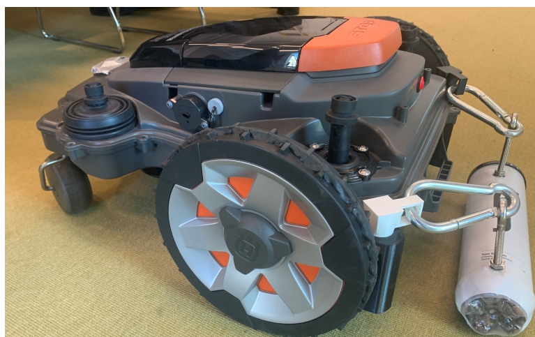
Figur 3.22: Figuren visar gräsklipparen utan skal och kamkonstruktion.
