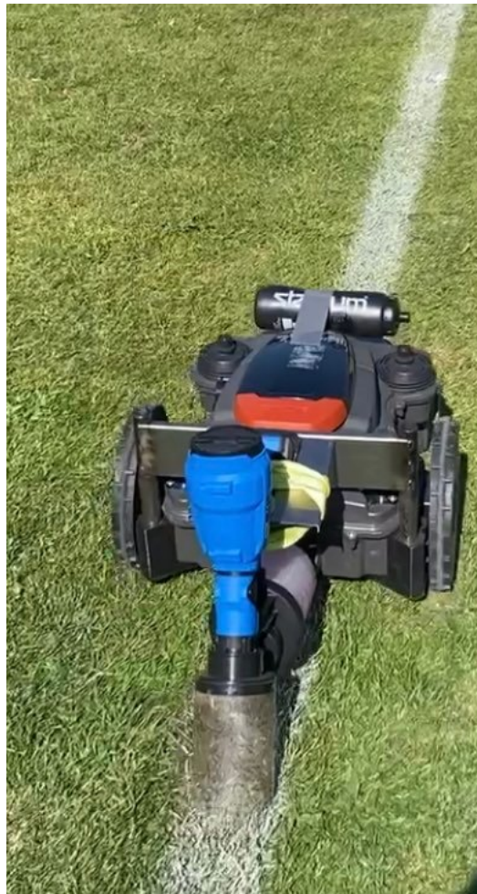
Figur 4.7: Figuren visar när gräsklipparen försöker måla längs mittlinjen.
