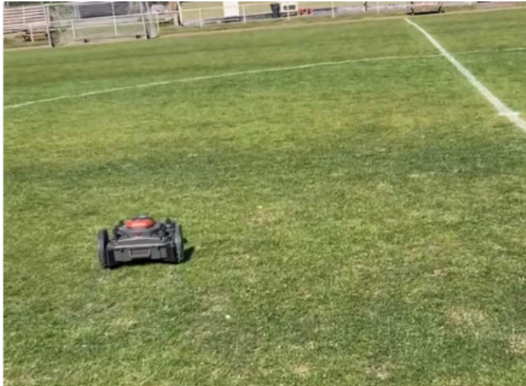
Figur 4.3: Figuren visar slutpositionen efter 40 meters körning med endast odometri utefter mittlinjen.
