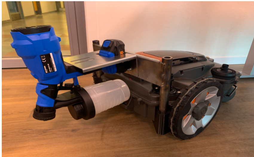
Figur 3.15: Figuren visar gräsklipparen utan skal med färgsprutarkonstruktionen.
