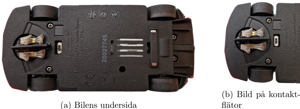
Figur 5: Den ursprungliga bilens undersida och närbild på kontaktflätor
