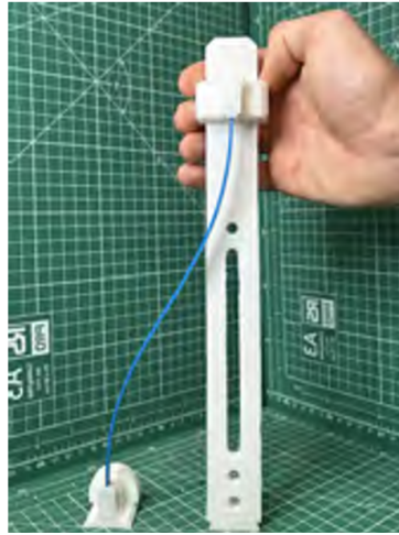
Figur 3.10: Illustration av hur föregående års kandidatarbete demonstrerade Eulerfall 5 genom att manuellt sidoställa en separat komponent. Bild hämtad från föregående års kandidatarbete 1 med tillstånd.
