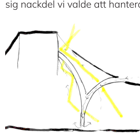
Kombinerade ventilations och ljusschakt.
