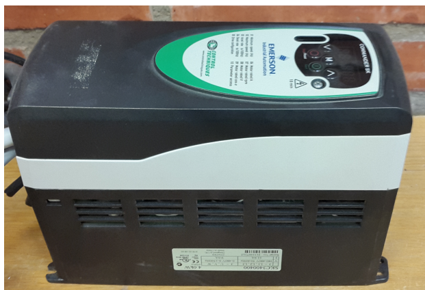
Figur 2.7: Frekvensomriktaren som används för att ändra motorns frekvens
