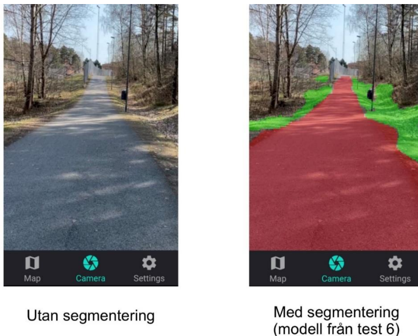
Figur 25. Till vänster i figuren visas en skärmbild på kamera-delen i applikationen utan segmentering när kameran är riktad mot en väg täckt av skuggor. Till höger i figuren har segmenteringsmodellen från test 6 aktiverats. Röd mask motsvarar klassen väg och grön mask motsvarar klassen gräs.
