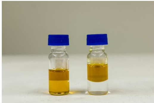
Figur 5. Bottle test för visuell observation. Vänster vial: RTD + UCO, inga synliga faser. Höger vial: UCO + vatten, två tydligt separerade faser.
