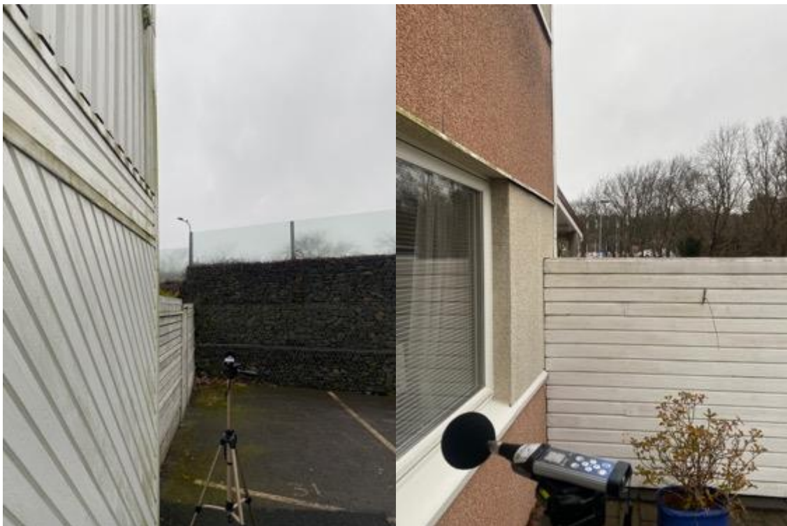
Figur A28: Exponerad fasad mot Kongahällavägen, utrustad med bullerskärm till vänster och skyddad fasad från Kongahällavägen till höger, M2.
