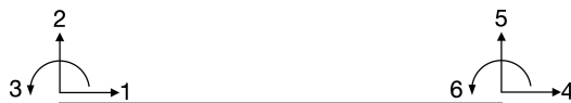
Figur 5.3: Ett broelement med tillhörande frihetsgrader. Hela brofarbanan har modellerats med totalt 10 element och 33 frihetsgrader.
