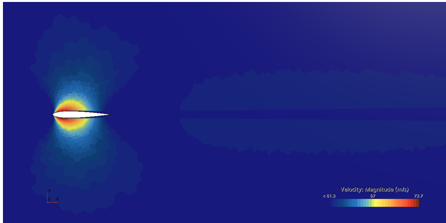
Figur A.17: Visualisering av luftflödet för vingen vid 37222 Re
