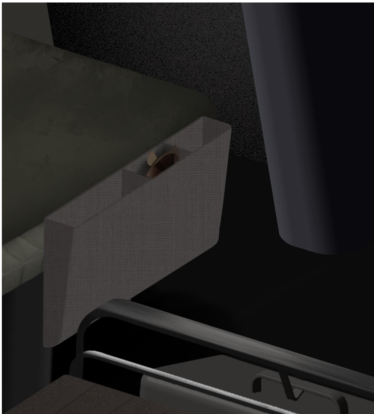
Figur 7.24: Bild på förvaringen vid förarsätet. Ett par solglasögon är placerade i det mellersta facket
