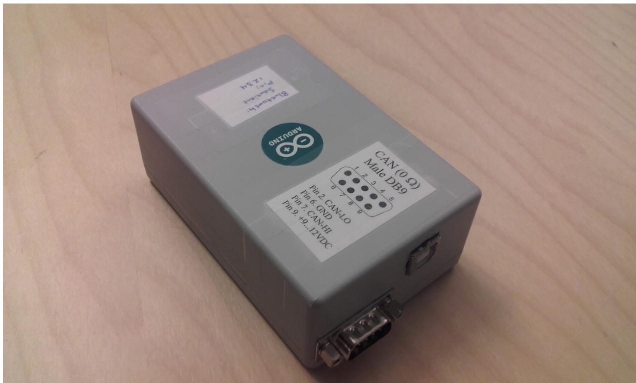
Figur 5.5: Arduinoenheten inbyggd i en låda för inkoppling i fordon med de två ingångarna synliga. CAN-ingången syns längst ner i bilden och USB-ingången till höger.
