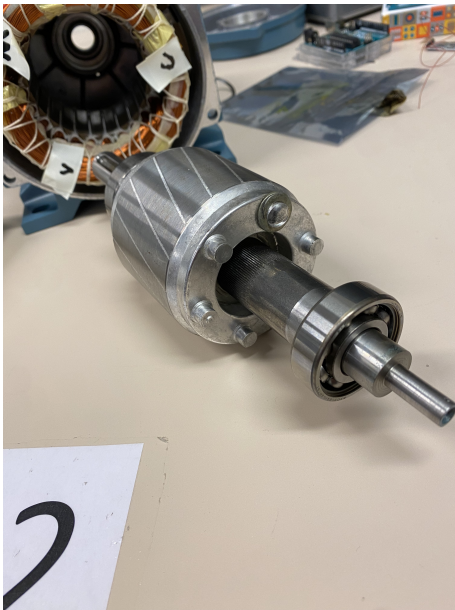
Figur 2.4: Bilden visar en rotor på en rotoraxel
