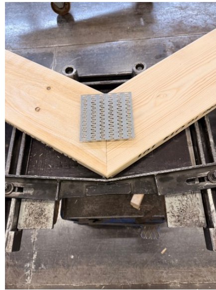
Figur 6: Utläggning av övre plåt.
