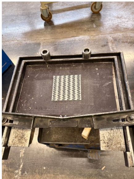
Figur 5: Utläggning av under plåt.
