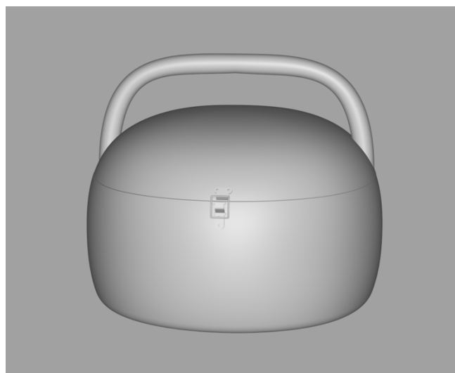
Figur 18: Cad-modell av kettlepot som inkluderar ett spännlås baserat på produkt GN 832. 4. Baserad på Wiberger (u.å.b).
