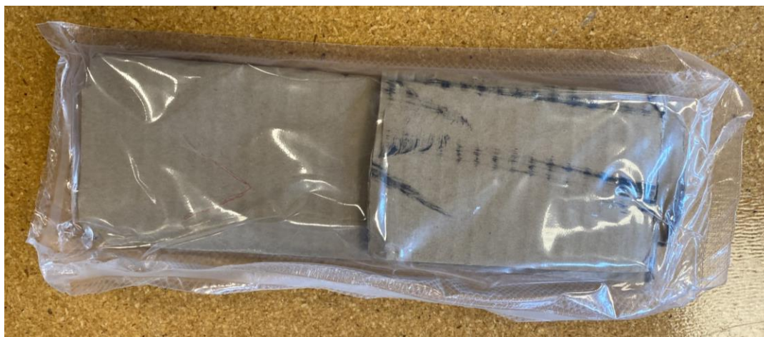
Figur 7 Isolering innan den sattes på plats i lådan för ett torktest
