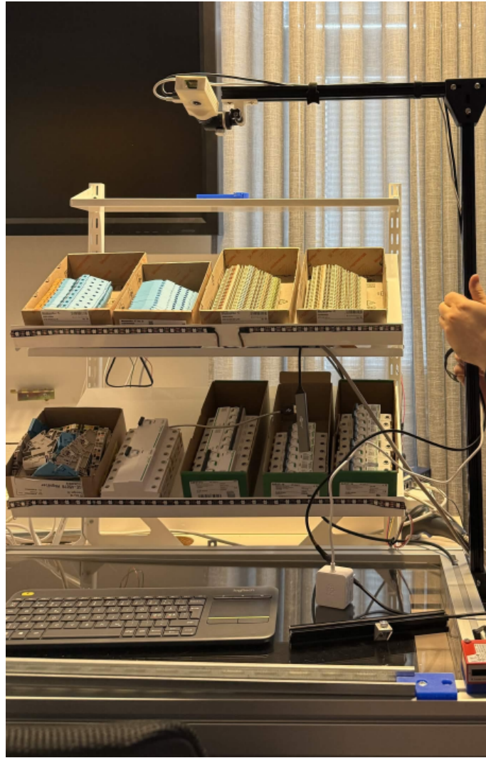
Figur 4.3: Kameran positionerad ovanifrån.
