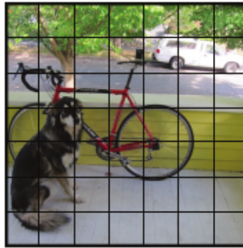
Figur 8: Exempel på hur en bild delas in i celler med S = 7 . Från [14].
