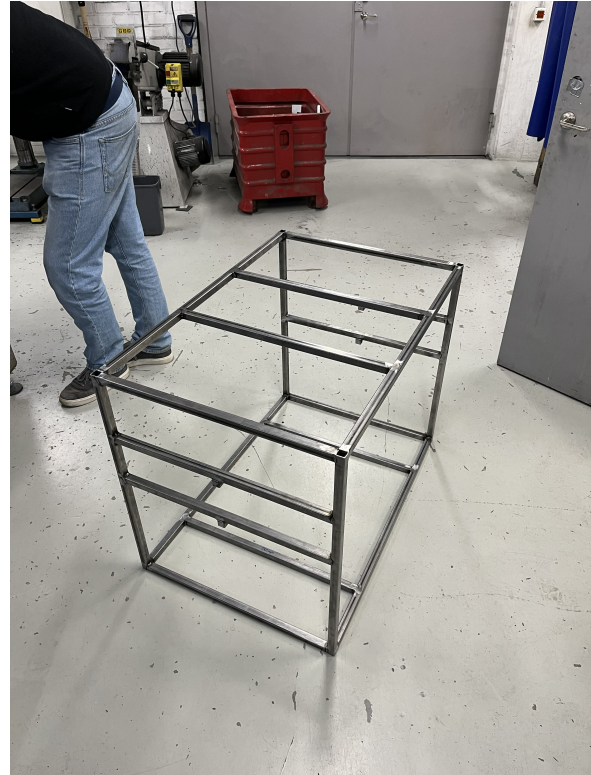
(b) Färdigsvetsad ramkonstruktion.
