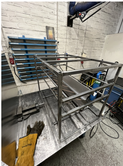
Figur 5.15: Montering av flaskhållare och interna stödstrukturer i ramkonstruktionen.
