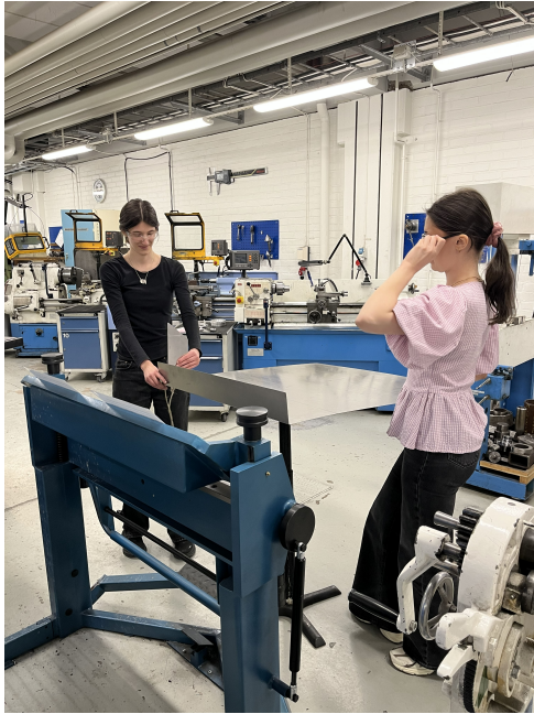
(a) Bockning av plåt för Trappan .
