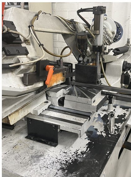
Figur 5.10: Kapning av fyrkantsrör i bandsåg under tillverkningsprocessen.
