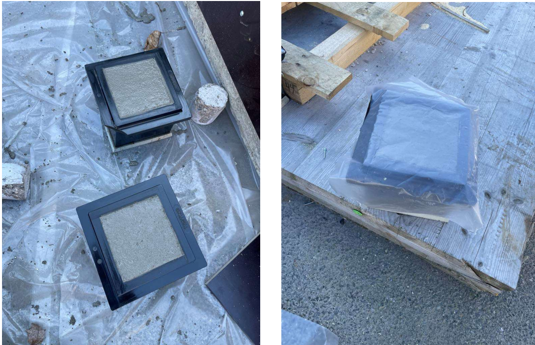
Figur 7.11: Gjutning av kuberna (Egna bilder, 2025)
