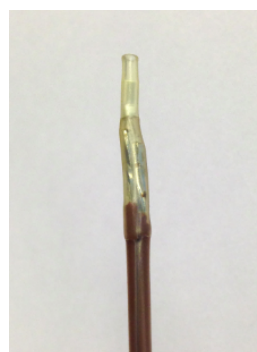
Figur 4.3: PT1000 ansluten till ledare samt krympslang
