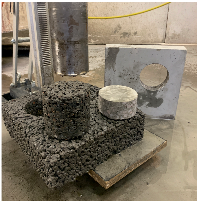
Figur 2.3: Borrkärnor av vanlig betong samt referensprovet.
