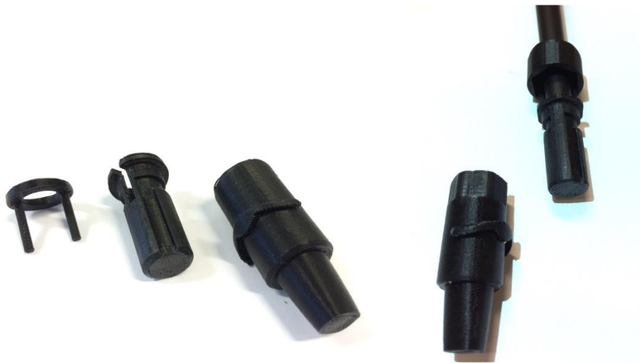
Figur 32. Utskriven 3D-modell av Bajonett med två olika varianter av låshylsa
