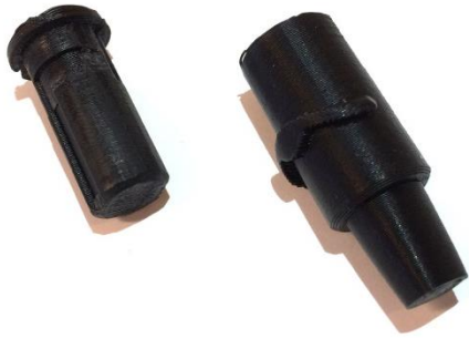
Figur 31. Utskriven 3D-modell av koncept Bajonett
