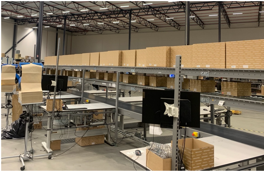
Figur 9: Bild av transportbandet som fungerar som buffert
