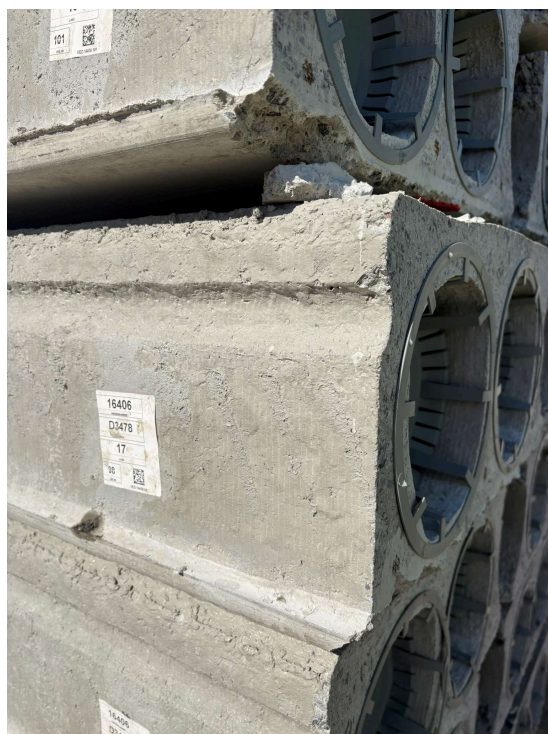
Figur 5 Sidovy på håldäckselement med kilformad gjutning och ojämn yta. (Författarens egna bild)
