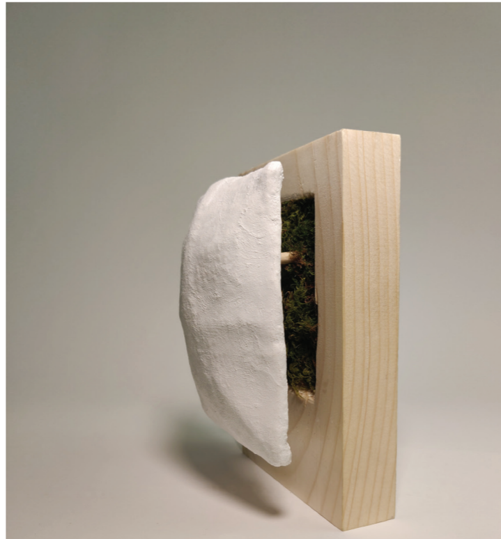
Modellbild av prototyp med absorpent bakom. Här är skärmen utskjuten, detta ger en kortare efterklangstid.
