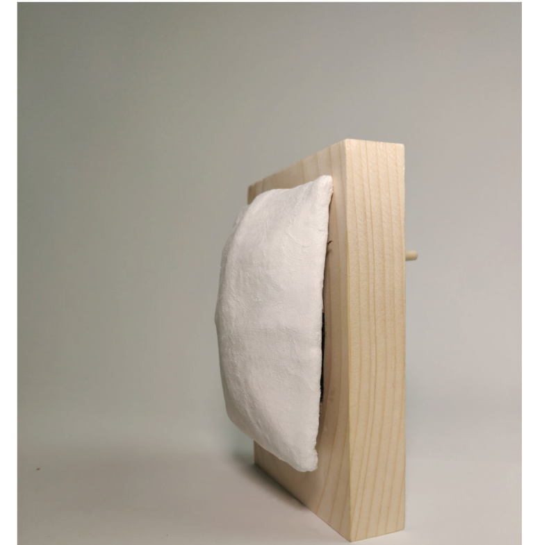
Modellbild av prototyp med absorpent bakom. Här är skärmen inskjuten, detta ger en längre efterklangstid.
