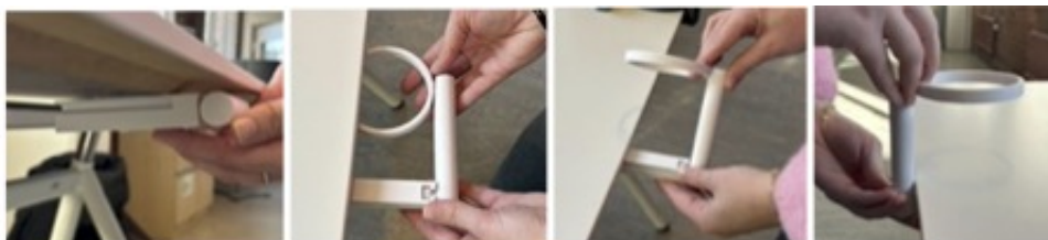
Figur 5.19: Konceptet: Bilhållaren. Sekvens som visar hur konceptet fälls upp från nedfällt läge till användningsläge
