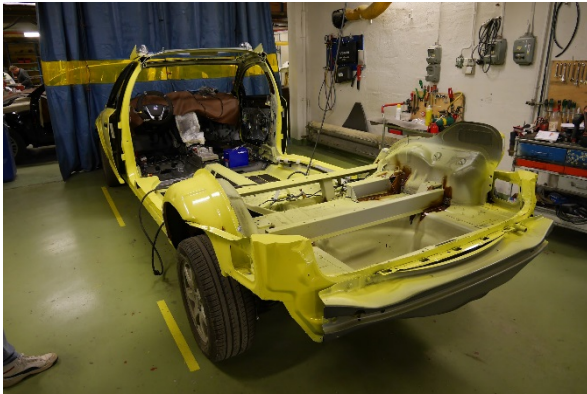
Figur 2.2: Kapat och förlängt chassi av Volvo XC90. Författarens egen bild.
