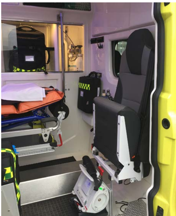
Figur 5.2: Vänster: Befintlig andra vårdarstol i Nilsson XC90 Ambulans. Höger: Simulering av Aide med utrustning placerad i vårdutrymme.
