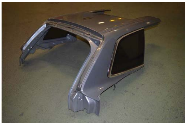
Figur 6.1: Avlägsnat takparti från nyinköpt Volvo XC90. Författarens egen bild.
