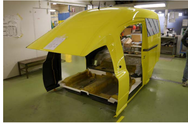
Figur 2.3: Nylevererad vårdhytt i kolfiber. Författarens egen bild.
