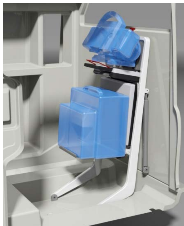
Figur 5.2: Vänster: Befintlig andra vårdarstol i Nilsson XC90 Ambulans. Höger: Simulering av Aide med utrustning placerad i vårdutrymme.
