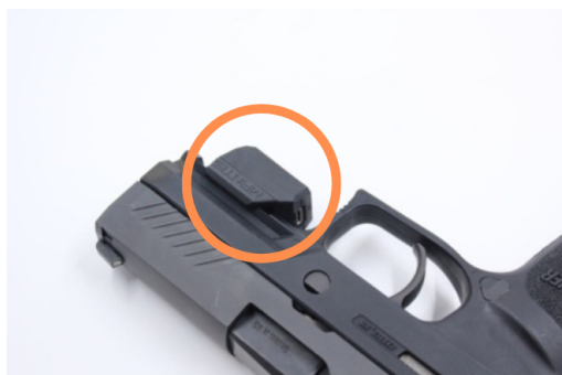
Figur 3.4. MantisX enhet applicerad på vapnets tillbehörsskena. (MantisX, u.å.-c). Återgiven med tillstånd.
