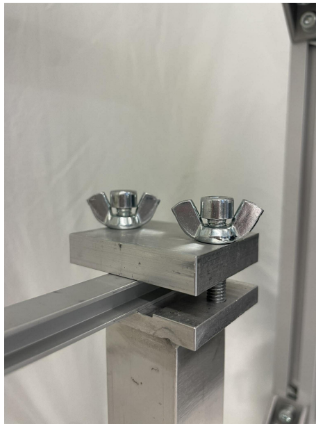
Figur 4.5: Lösning med vingskruvar för enklare hantering
