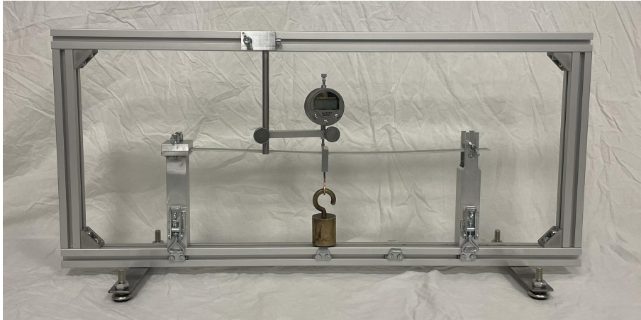
Figur 4.1: Kompletta rigg med mätklocka och platt balk
