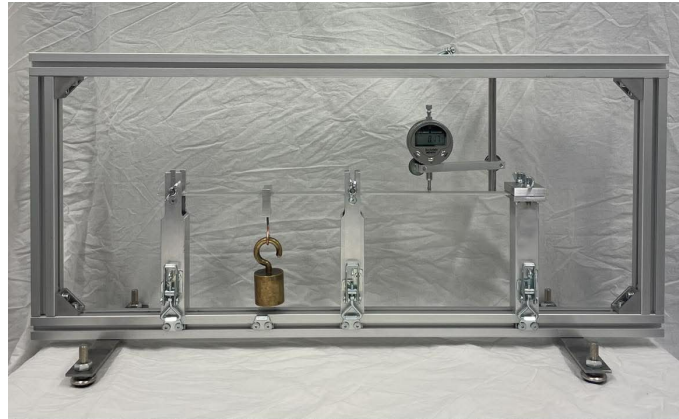
Figur 4.14: Lastfall med fast inspänning och två rullstöd
