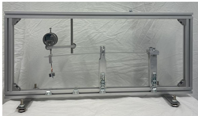
Figur 4.13: Lastfall med fast inspänning, rullstöd och fri ände
