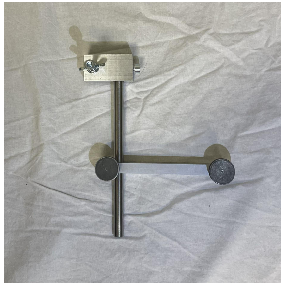
Figur 4.8: Arm för att fästa mätklockan i ramen och för att kunna flytta den längs med balken
