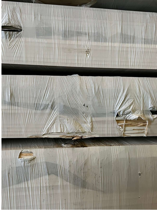
Figur 4. Fotografi på skadade virkespaket i centrallagret.
