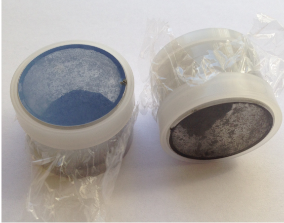
Bild 4: På bilden ser man två provkoppar från XRF analysen med slamprover i, man ser även att de är täckta med en plast så att provet går att genomstrålas utan större interferens.
