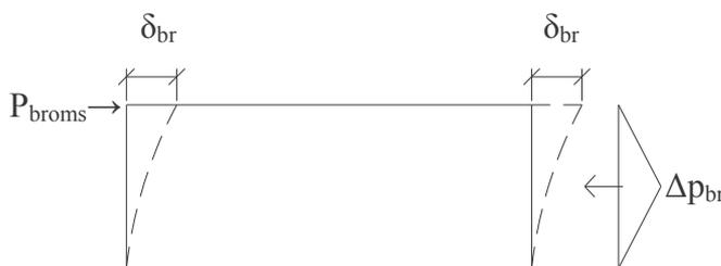
Figur 24: Ökat jordtryck på grund av rörelse mot fyllning av bromskraft.
