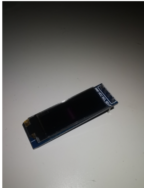
Figur 2.6: Mini-OLED-skärm med 128x32 vita pixlar med drivrutinschippet SSD1306 och I2C-kommunikation.
