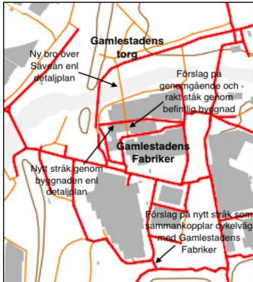
Figur 25. Visar hur områdets gatunätverks tillgänglighet påverkas i området av författarnas förslag, vilket är att förlänga stråket som skapas av en ny bro genom den befintliga byggnaden och skapa ett rakt och genomgående stråk. Samt förslag på att skapa ett nytt stråk som sammankopplar en cykelväg och gångväg från Bagaregården/Olskroken med Gamlestadens Fabriker.
