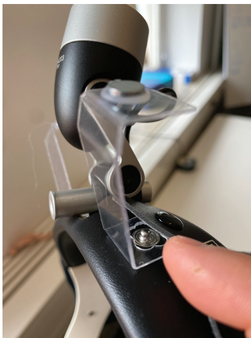
Figur 34. Sprötens montering på Storz-kronan.
