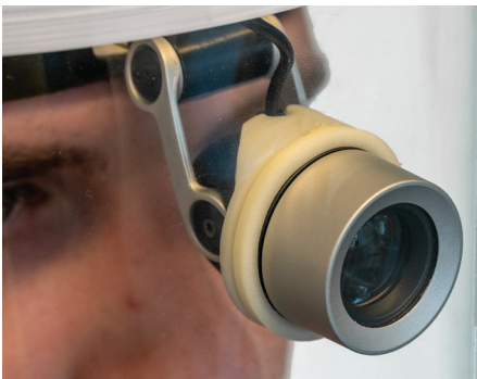
Figur 56. Slutkoncept fäste på Storz-kronan.
