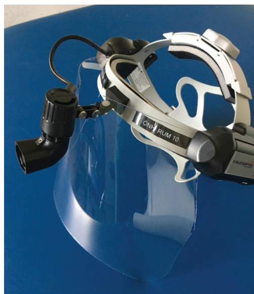
Figur 20. Sahlgrenskas hemmabyggt lösning på pannlampa och visir.
