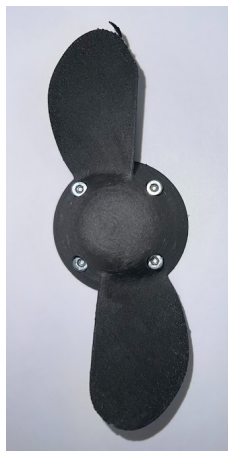
Figur 5.5: Sprickbildning vid bladets ytterkant på den tvåbladiga propellern efter test.
