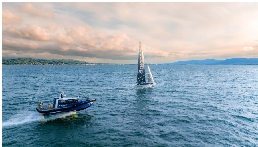
Figur 1.1: Artemis foilandande arbetsbåt EF12 och den svenska AC40 från America's Cup. Foto: Artemis Technologies
