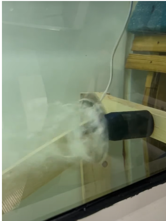
Figur 5.2: Ventileringfenomen vid test av tvåbladig aluminium-propeller
