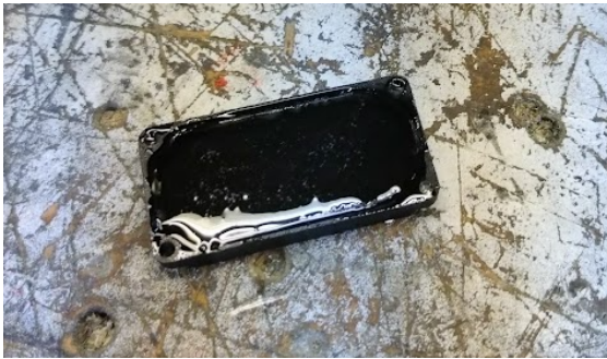
(a) Nedre delen fylld med epoxi
