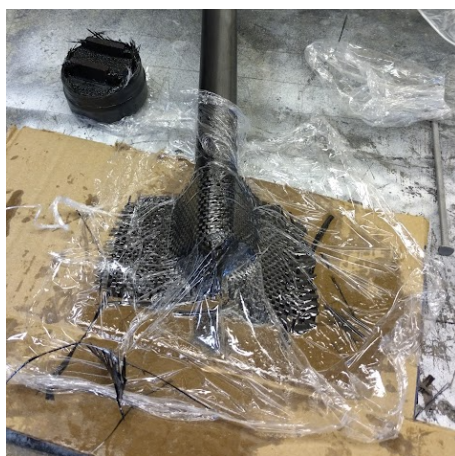
Figur 3.9: Förstärkning av sensorfäste med hjälp av kolfiber-laminering
