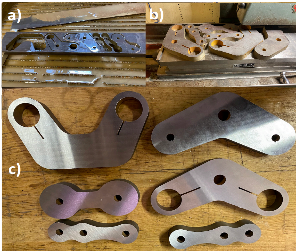
Figur 27: Plåt detaljer a) Vattenskrurna detaljer, b) Samma detaljer vid planslipning, c) Detaljer färdiga för individuell bearbetning
