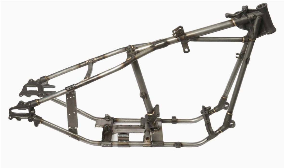
Figur 4: Original Harley Davidson El ram, vilken leverades med SFG (Calles Chopperdelar, 2024).
