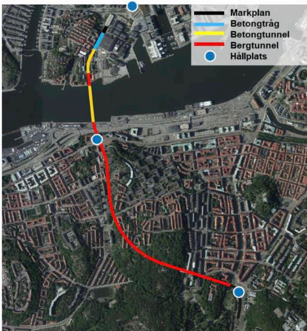
Figur 2 Tunnelalternativet (Göteborgs Stad; Trafikkontoret, 2020)
