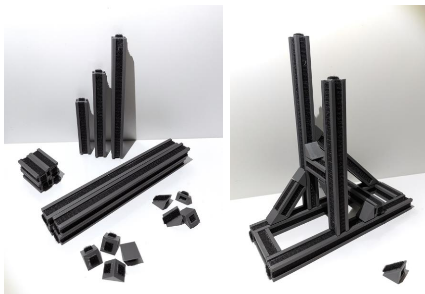
Figur 4.46 och 4.47: Bild på den utskrivna byggsatsen med kardborreband monterat. Författarens egen bild.
