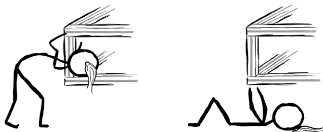
Figur 4.1: Skisser som visar mindre bra ergonomiska ställningar för åtkomst. Författarens egen bild.
