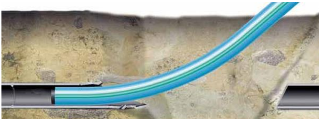
Figur 6. Infördring av kontinuerligt rör. (Norsk Vann, 2016). Återgiven med tillstånd.
