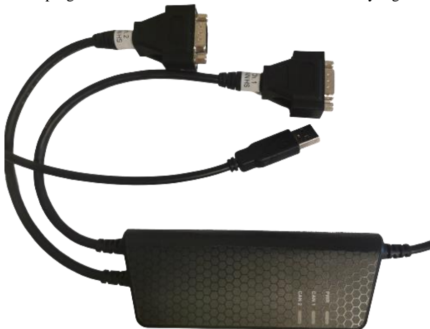
Figur 6: USBcan Pro med USB-kontakt och två D-SUB9 kontakter
