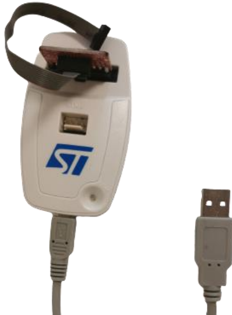
Figur 7: ST-LINK/V2 med USB-kontakt och koppling till CPU-nodskortet
