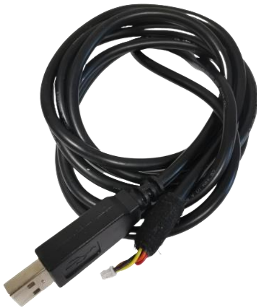
Figur 8: Debuggladd för Tera Term med USB-kontakt
