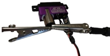
Figur 11: spänningskablar ihopkopplade med servots motor med hjälp av krokodilklämmor
