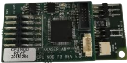
Figur 3: CPU-nodskortet som sitter på bärarkortet
