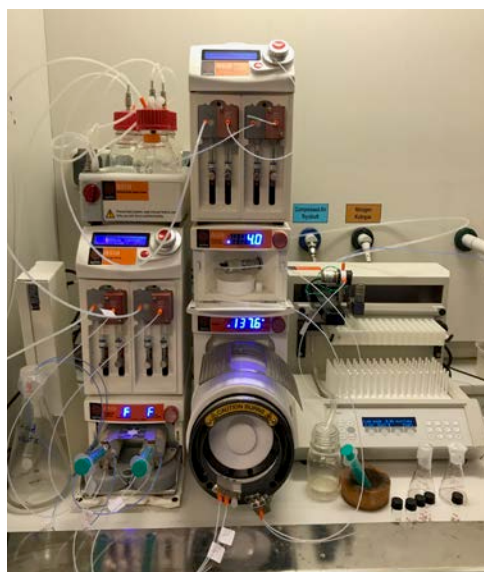
Figur 4 Uppsättning av flödesreaktorn och tillhörande delar
