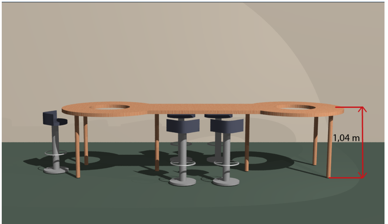
Figur 48, konferensträdet sidovy med mått. Författarens egen bild.
