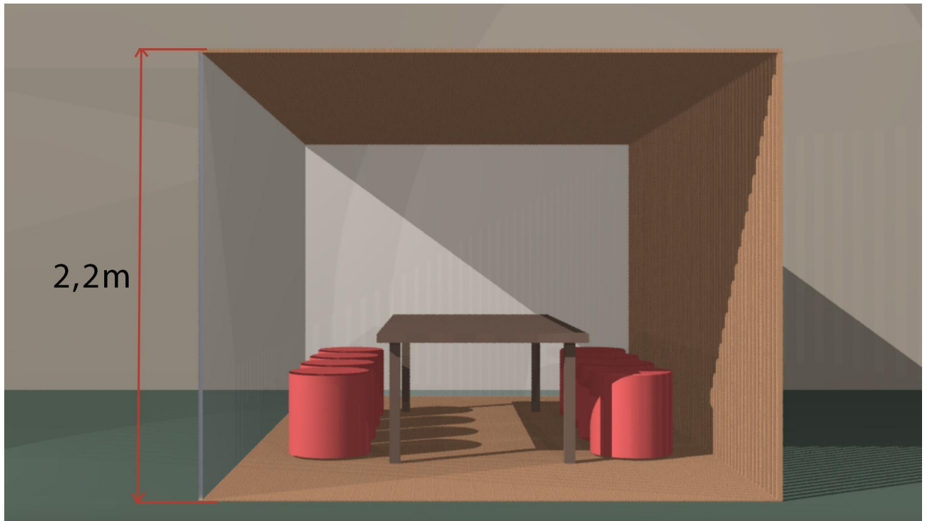
Figur 39, glaskupan sidovy med mått. Författarens egen bild.
