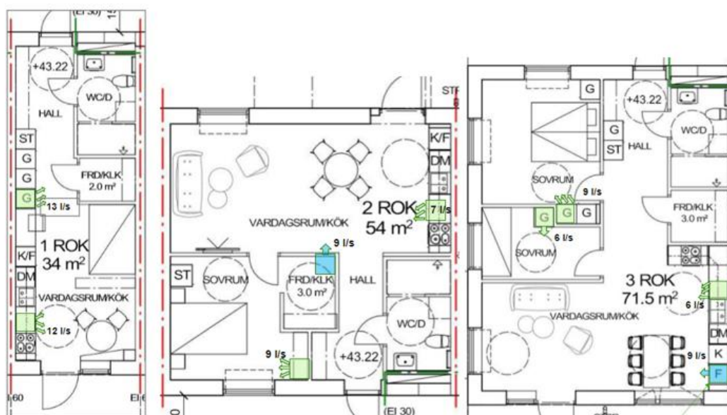
Figur 6 är en planbeskrivning över de olika lägenhetsstorlekarna och visar vart Parasocklarna är placerade. Grönt beskriver att Parasockeln är placerad efter golvet och blått högre upp mot tak. Lägenheten till vänster är 1 RoK, mittenlägenheten är 2 RoK och den högra lägenheten är 3 RoK.
