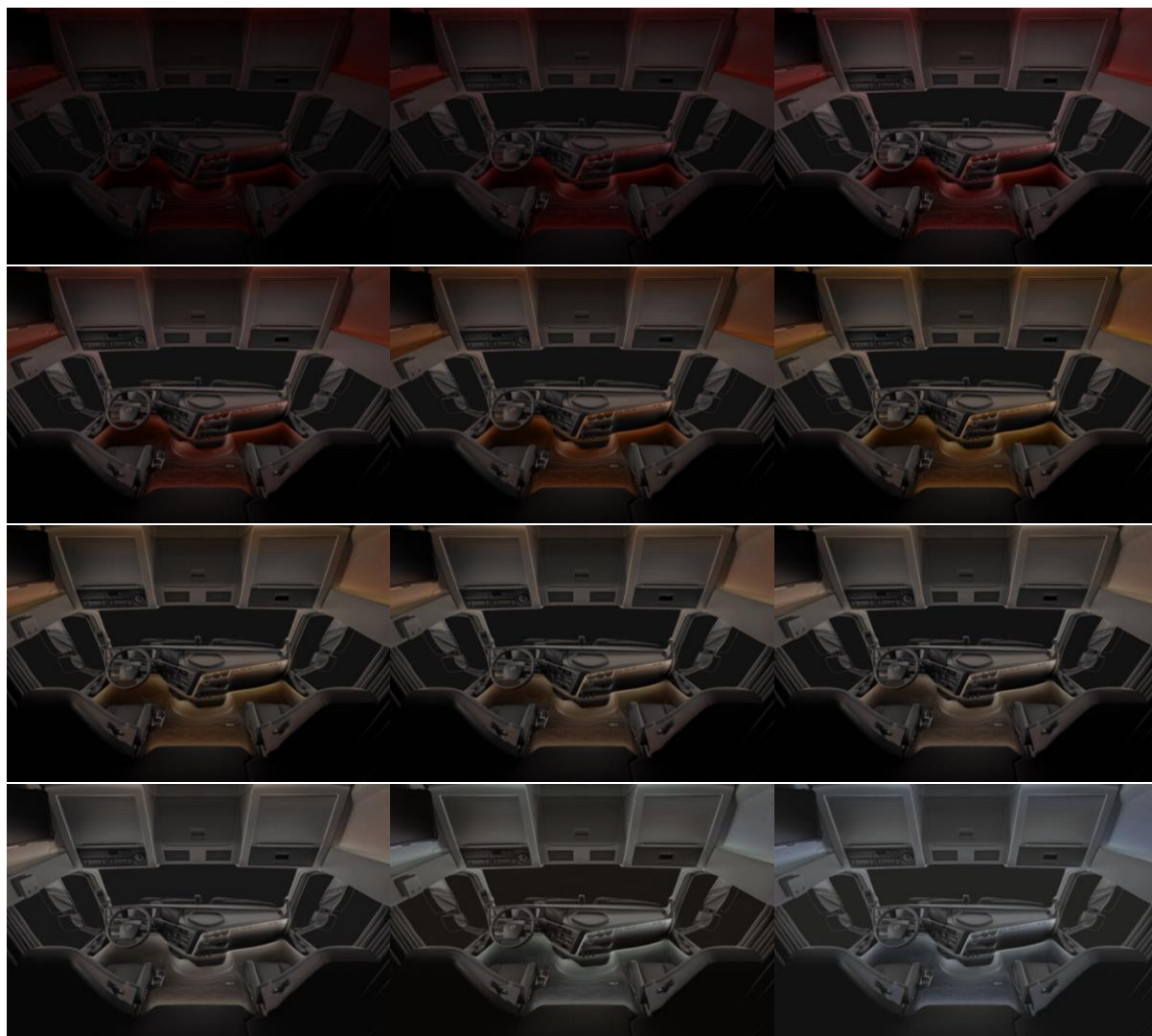
Figur 4 - Film på wake-up-funktion där ljuset går från svagt och rött till vitt ljus via orange och gult ljus. Originalbild hämtad 2023-03-21, från https://www.volvotrucks.se/sv-se/ , använd och redigerad med tillåtelse.
