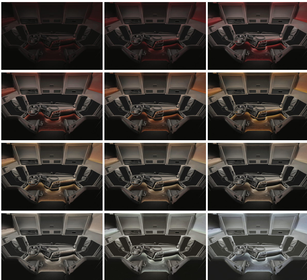
Figur 27 - Visualisering av LUMINAs väckningsfunktion från början till slut. Originalbild hämtad 2023-03-21, från https://www.volvotrucks.se/sv-se/ , använd och redigerad med tillåtelse.
