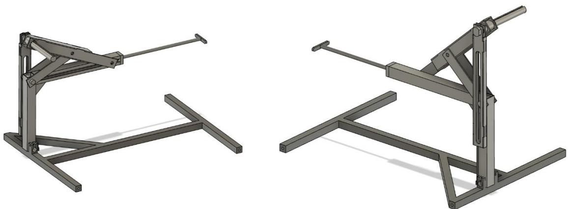
Figur 77 Scott Russell monterad på en bas som sedan monteras på ett lyftbord. Visas i två vyer.
