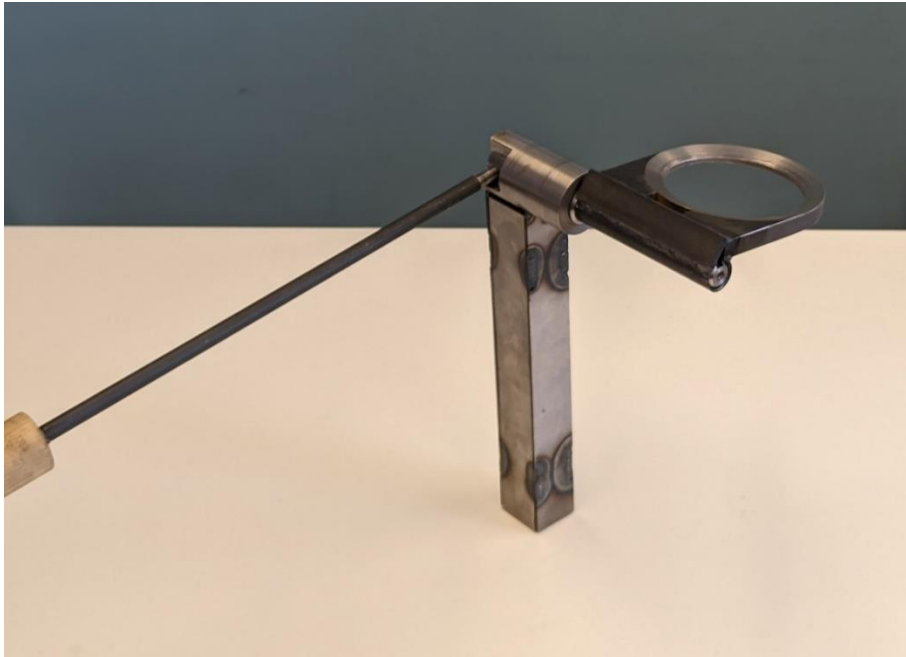
Figur 79 Prototyp av Scott Russell med en del av adaptorn monterad för att visa vart drivenheten placeras.
