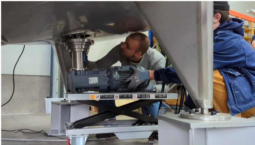
Figur 5 Ett exempel av en dålig arbetsposition vid montering av drivenhet med hjälp av ett lyftbord.
