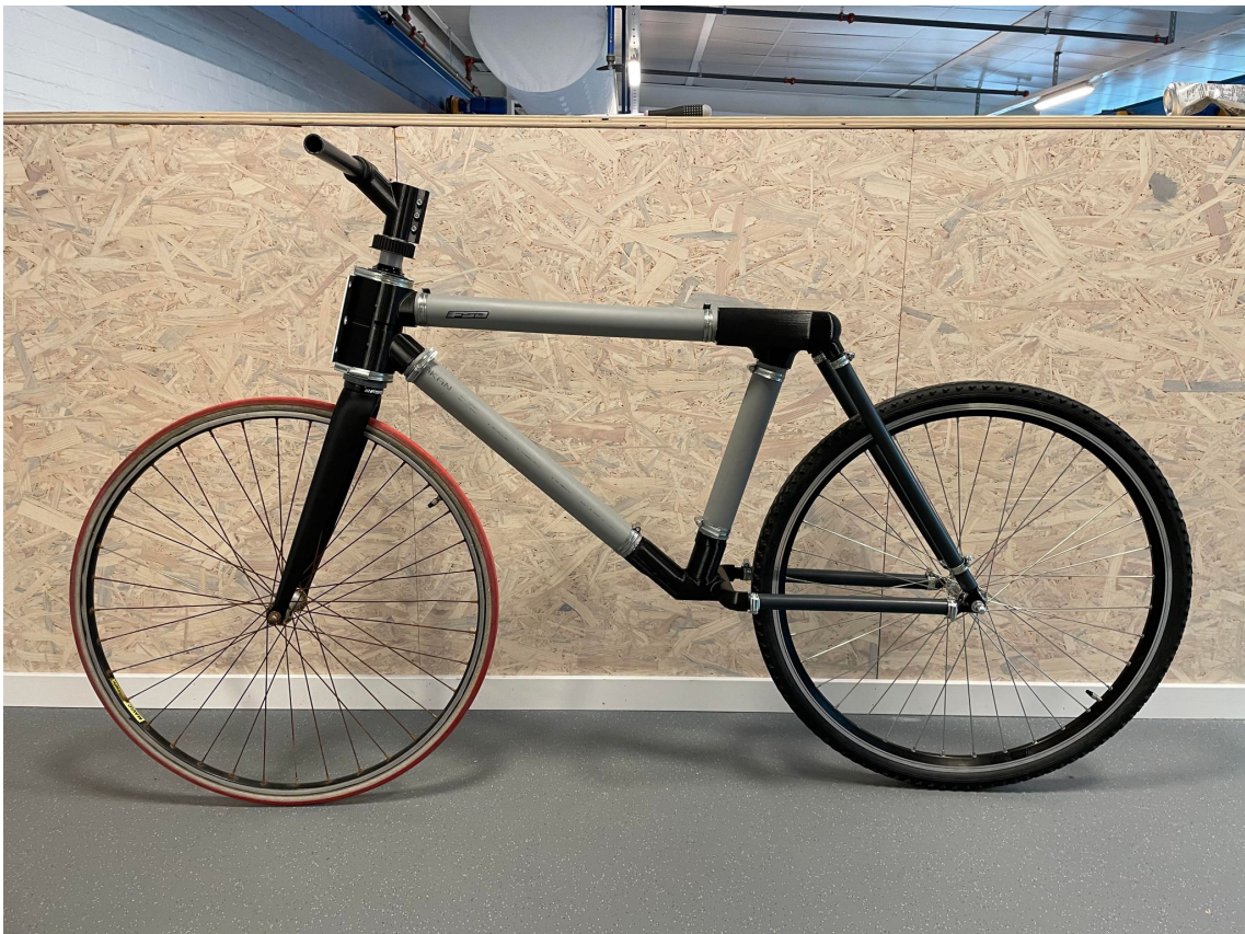
Figur 5.1: Cykel med framgaffel i kolfiber och huvudvinkel, \lambda = 73^\circ
