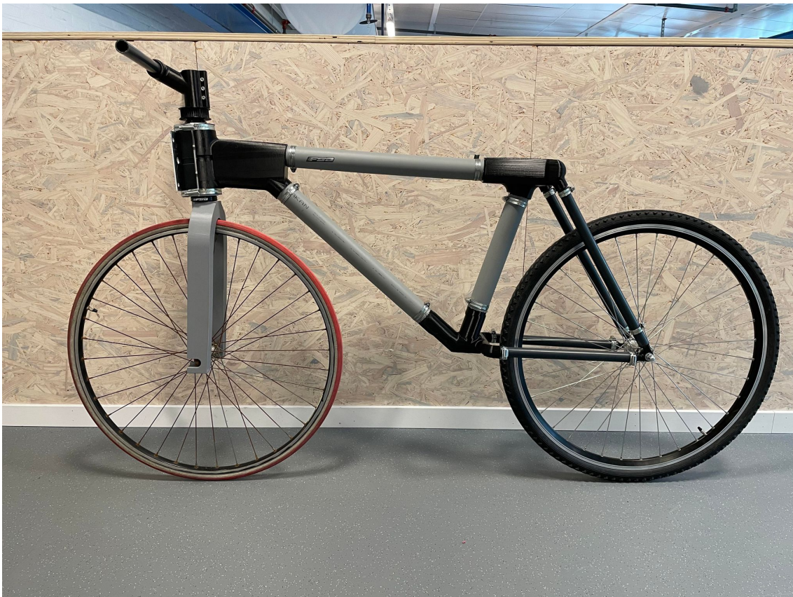
Figur 5.4: Cykel med framgaffel i PETG-plast och huvudvinkel, \lambda = 90^\circ
