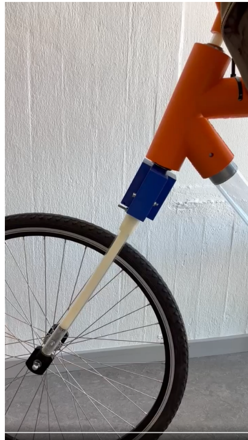
Figur 1.5: Framgaffel efter pålagd belastning
