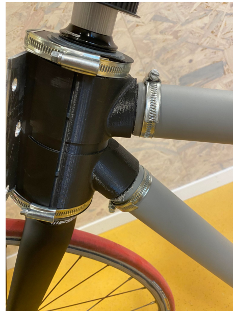
Figur 3.16: Infästning innan montering Figur 3.17: Infästning efter montering
