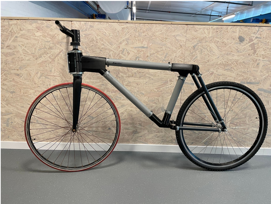
Figur 5.2: Cykel med framgaffel i kolfiber och huvudvinkel, \lambda = 90^\circ
