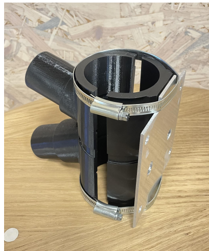
Figur 3.3: Bakre och främre del monterad med slangklämmor och aluminiumfäste för styrmotorn.
