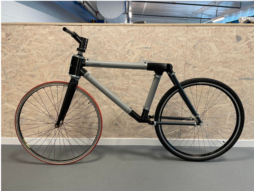
Figur 6.5: Slutgiltig cykel med framgaffel i kolfiber och huvudvinkel, \lambda = 73^\circ
