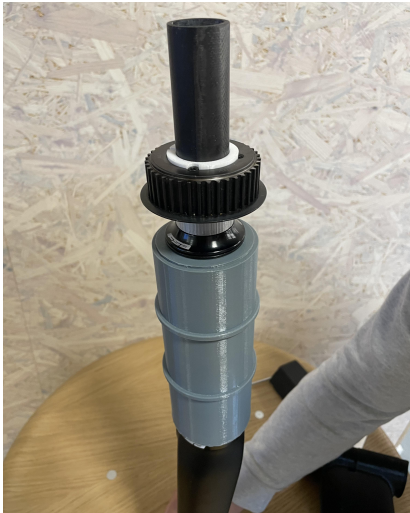
Figur 3.4: Mittenmodul som fäster framgaffel med kullager och remskiva
