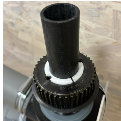
Figur 3.5: Infästning av remhjul på kolfiberframgaffel
