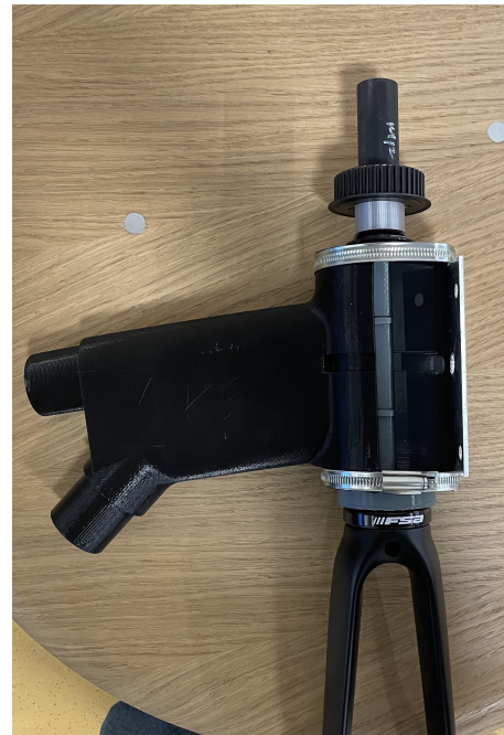
Figur 3.8: Färdigmonterad kronmodul med 90° huvudvinkel.
