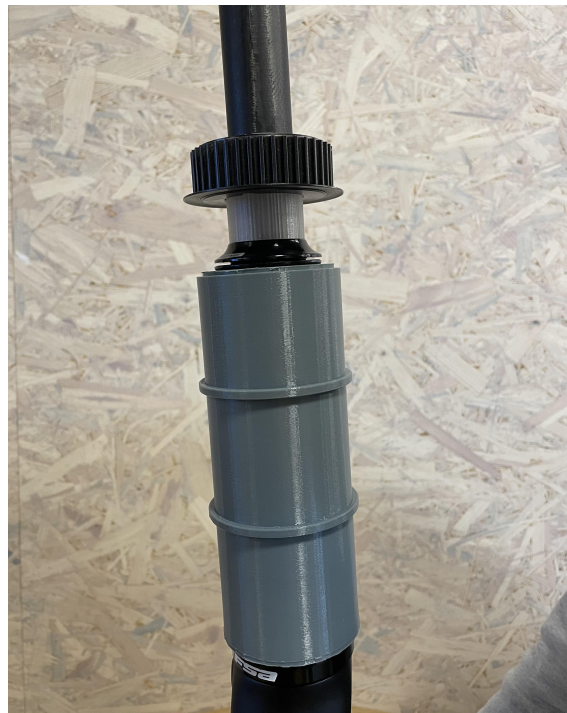
Figur 3.6: Remhjul som pressar mot distans och styrlager.
