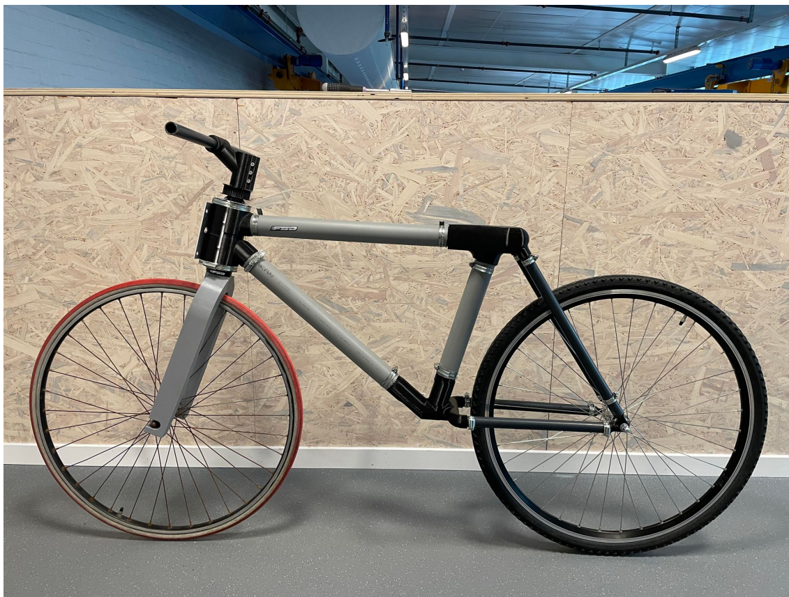
Figur 5.3: Cykel med framgaffel i PETG-plast och huvudvinkel, \lambda = 73^\circ
