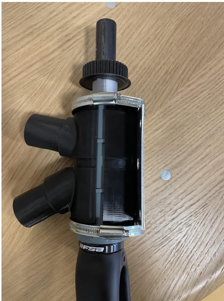
Figur 3.7: Färdigmonterad kronmodul med 73° huvudvinkel.
